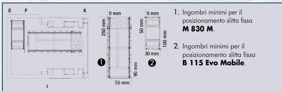
1. Ingombri minimi per il posizionamento slitta fissa **M 830 M**.
