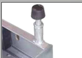
Particolare leverismo di spunto , che permette di sollevare carichi già ad altezze minime.
