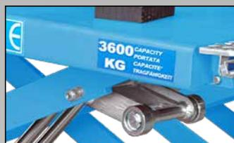
**Boulon réglable** avec caoutchouc d'amortissement de fin de course.
