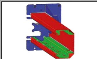
Struttura colonna rinforzata internamente **per ridurre la flessione e guida cavi interna**.
