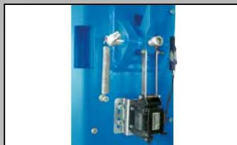
Sblocco sicure con **elettromagnete 24V**.
