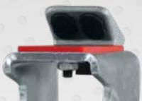
Neues, modulares Spannsystem mit **Schutzelementen aus Kunststoff** zum Auflegen der Felge sowie für den am Profil spannenden Teil.
