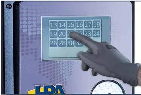
Impostazione dimensione ruota in pollici (13" ÷ 32") ed autopoizionamento radiale ottimale della stessa rispetto al "revolver" automatico.
