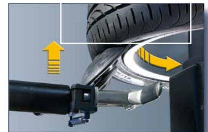
Successivamente, il disco stallonatore inferiore preme da sotto e la contemporanea rotazione della ruota facilita la stallonatura inferiore.
