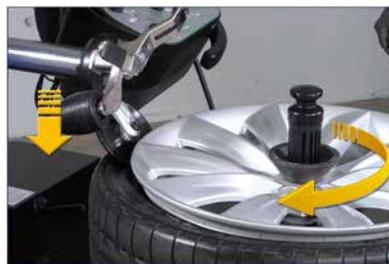
Il disco stallonatore del revolver preme idraulicamente sullo pneumatico e la contemporanea rotazione della ruota facilita la stallonatura superiore.
