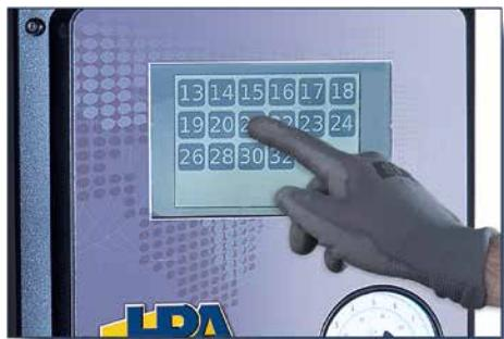
Einstellung der Radgröße in Zoll (13 "bis 32") Und effektivste Automatische Positionierung des radialen Rads Hinsichtlich des Fahrt "Revolver".
