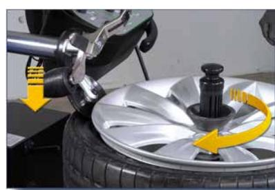
El disco destalonador del revolver presiona hidráulicamente el neumático y el movimiento de la rueda que se produce al mismo tiempo, facilita la destalonadura superior.
