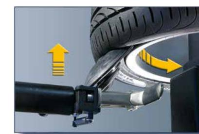
El disco destalonador inferior presiona hidráulicamente el neumático desde abajo y el movimiento de la rueda al mismo tiempo, facilita la destalonadura inferior.
