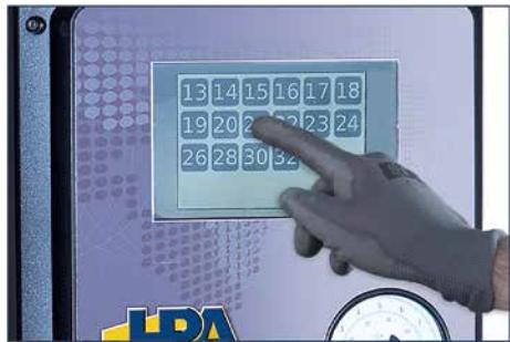
Configuración dimensión de la rueda en pulgadas (13" ÷ 32") y posicionamiento automático radial óptimo de la misma con respecto al "revolver" automático.
