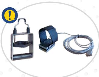
MISURATORE DI SFORZO AL PEDALE E FRENO A MANO
