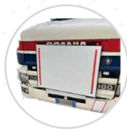
**TARGET** da installarsi nella parte anteriore del veicolo in prova
