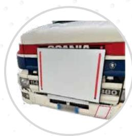
**TARGET** da installarsi nella parte anteriore del veicolo in prova
