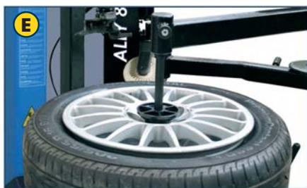
**E. Felgeniederhaltekegel.** Erleichtert das einspannen der felge am spannteller im falle von steifen Reifen.
